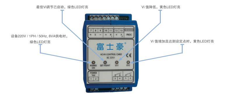
该设备安装在压缩机电气接线盒内
